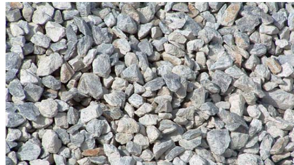
Gravilla utilizada en algunos casos, en arriates o alcorques
